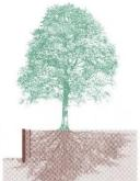
Beim Aushub von Baugruben im Schutzbereich des Baumes ist ein **Wurzelvorhang** zum Schutz vor Austrocknung und Frosteinwirkung herzustellen (siehe ÖNORM L1121)
