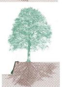
Bei der Verlegung von Leitungen im Kronentraufenbereich gilt: Pressvortrieb von Futterrohren verletzt die Wurzeln weniger als die Grabung von Leitungsschächten.
