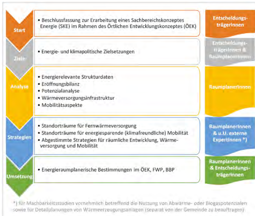
Abb. 1: Arbeitsschritte und Zuständigkeiten im Rahmen der Erstellung des Sachbereichskonzeptes Energie (Quelle: SKE - Leitfaden, V 2.0)
